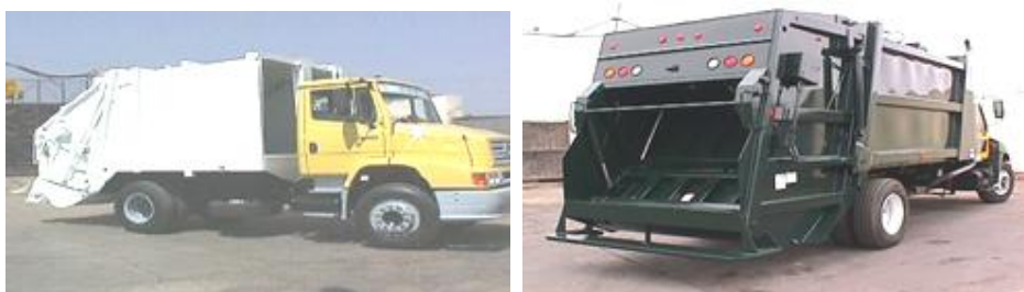
Imagen 2 Recolector compactador de carga trasera 15 y 19m 3
