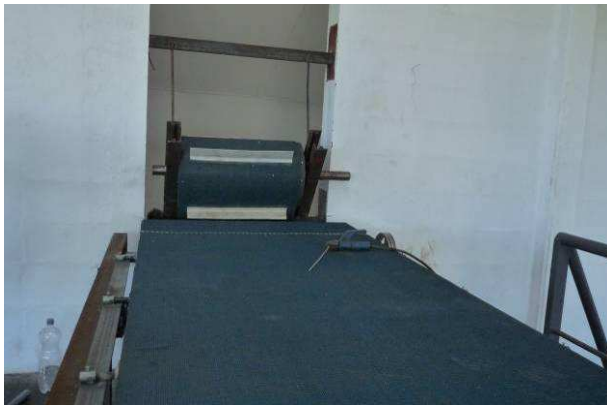
Tren de clasificación: cinta transportadora elevada y orificios para reciclables clasificados
