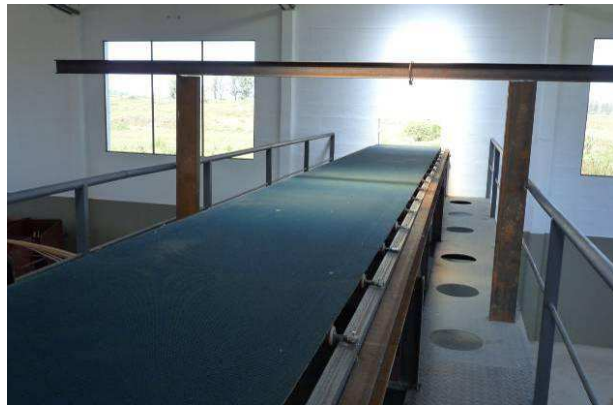
Tren de clasificación: cinta transportadora elevada y orificios para reciclables clasificados
